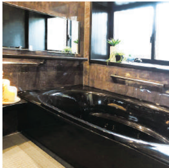
タイル貼りの寒いお風呂を、一まわり小さくして断熱サッシの出窓を設置。暖かくなり、心地いい浴室に
